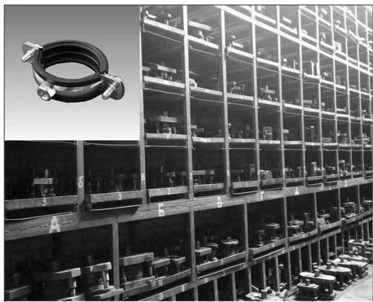
Рис. 1. Штамповая оснастка для различных конфигураций изделия «Хомут трубный»
